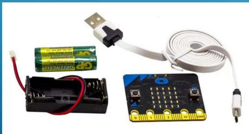
La scheda misura 4×5 cm e integra 25 LED (5×5), che possono essere utilizzati per visualizzare messaggi. Presenta anche due pulsanti programmabili e cinque anelli I/O per connettere dispositivi o sensori esterni. Monta un processore ARM Cortex M0 a 32 bit con Bluetooth, una bussola digitale-magnetometro, un accelerometro e un connettore microUSB
