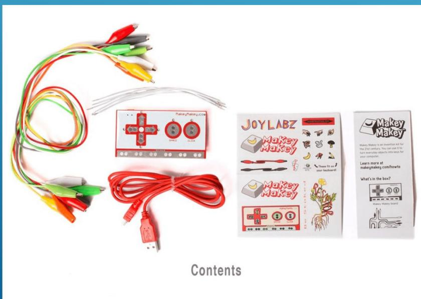
Makey Makey combina realtà fisica ed Internet, permettendo di usare oggetti di uso comune per controllare circuiti e computer. Crea un touchpad con qualsiasi materiale conduttore attaccandolo a Makey Makey tramite le pinze a coccodrillo
